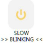
Wenn Sie den Scanner ausschalten, blinkt die Anzeige orange, bevor das System heruntergefahren wird.
