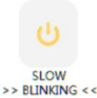
Wenn die orangefarbene LED blinkt, sollte der Akku sofort gewechselt werden, da sich der Scanner sonst nach 5 Minuten ausschaltet.
